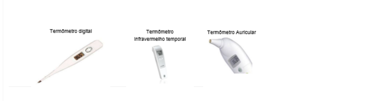
Figura 01- Tipos de Termômetros mais comuns para aferição externa da temperatura
